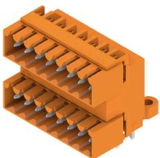
Connettore maschio su due file per saldatura ad onda nel passo 3,50 mm. Il giunto è disponibile in versione aperta, chiusa e con flangia. I connettori maschio dispongono di spazio per la siglatura e sono codificabili. Imballaggio in scatole di cartone.
