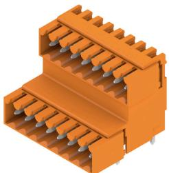
Striscia di connettori maschio stratificati su due livelli per saldatura a onda in passo 3,50 mm. Disponibili in versione chiusa e con flangia. I connettori maschio dispongono di spazio per la siglatura e sono codificabili.
