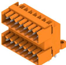
Connettori maschio su due file per saldatura ad onda nel passo 3,50 mm. Il giunto è disponibile in versione aperta, chiusa e con flangia. I connettori maschio dispongono di spazio per la siglatura e sono codificabili. Imballaggio in scatole di cartone.
