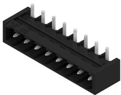
Connettore maschio aperto, diritto, resistente alle alte temperature Imballaggio in scatola o Tape. Su Tape e con codolo a saldare da 1,5 mm, ottimizzati per l'equipaggiamento automatico. Codolo a saldare da 3,2 mm, indicato per saldatura reflow e a onda. Le strisce di connettori maschio presentano uno spazio per la siglatura e sono codificabili. HC = High Current (a corrente forte).
