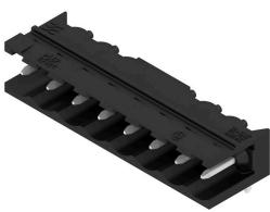
Connettore maschio aperti, angolati a 90°, resistenti alle alte temperature. Imballaggio in scatola o Tape. Su Tape, con codolo a saldare da 1,5 mm, ottimizzati per l'equipaggiamento automatico. Codolo a saldare da 3,2 mm, indicato per saldatura reflow e a onda. Le strisce di connettori maschio presentano uno spazio per la siglatura e sono codificabili. HC = High Current (a corrente forte).
