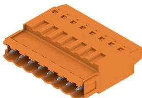
Connettore maschio con collegamento a vite in tecnica TOP per l'allacciamento del conduttore. I connettori maschio presentano uno spazio per la siglatura e possono essere codificati.
