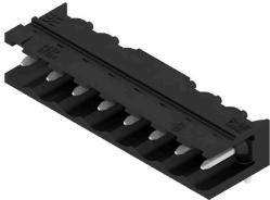
Connettori maschio aperti, angolati a 90°, resistenti alle alte temperature. Imballaggio in scatola o Tape. Su Tape, con codolo a saldare da 1,5 mm, ottimizzati per l'equipaggiamento automatico. Codolo a saldare da 3,2 mm, indicato per saldatura reflow e a onda. Le strisce di connettori maschio presentano uno spazio per la siglatura e sono codificabili. HC = High Current (a corrente forte).
