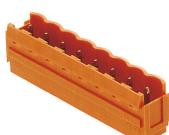
Connettori maschio con direzione d'uscita diritta a 180°. La lunghezza dei codoli a saldare è ottimizzata per saldature ad onda. I connettori presentano uno spazio per la siglatura e possono essere codificati.
