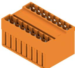
Connettori maschio a due piani con layout d#92innesto parallelo. La lunghezza dei codoli a saldare è ottimizzata per saldature ad onda. I connettori presentano uno spazio per la siglatura e possono essere codificati.
