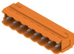
Connettori maschio con direzione d#92 uscita a 90°. La lunghezza dei codoli a saldare è ottimizzata per saldature ad onda. I connettori presentano uno spazio per la sigillatura e possono essere codificati.
