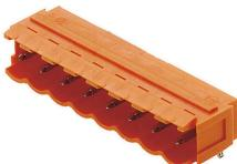
Connettori maschio con direzione d'uscita a 90°. La lunghezza dei codoli a saldare è ottimizzata per saldature ad onda. I connettori presentano uno spazio per la siglatura e possono essere codificati.
