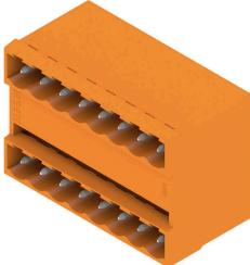
Connettori maschio a due piani con layout d#92innesto parallelo. La lunghezza dei codoli a saldare è ottimizzata per saldature ad onda. I connettori presentano uno spazio per la siglatura e possono essere codificati.
