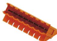
Connettori maschio con direzione d'uscita a 135°. La lunghezza dei codoli a saldare è ottimizzata per saldature ad onda. I connettori presentano uno spazio per la siglatura e possono essere codificati.
