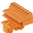
Connettori femmina con collegamento a vite in tecnica a staffa di serraggio per il collegamento del conduttore I connettori sono montati su guida di supporto con i piedi di bloccaggio. I connettori maschio presentano uno spazio per la siglatura e possono essere codificati.
