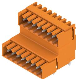
Striscia di connettori maschio stratificati su due livelli per saldatura a onda in passo 3,50 mm. Disponibili in versione chiusa e con flangia. I connettori maschio dispongono di spazio per la siglatura e sono codificabili.
