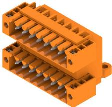
Connettore maschio su due file per saldatura ad onda nel passo 3,50 mm. Il giunto è disponibile in versione aperta, chiusa e con flangia. I connettori maschio dispongono di spazio per la sigillatura e sono codificabili. Imballaggio in scatole di cartone.
