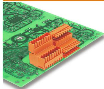
Striscia di connettori maschio stratificati su due livelli per saldatura a onda in passo 3,50 mm. Disponibili in versione chiusa e con flangia. I connettori maschio dispongono di spazio per la siglatura e sono codificabili.
