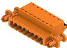
Connettore maschio con tecnica di collegamento PUSH IN con direzione di uscita diritta, insieme a BLF 5.08HC come applicazione Wire-to-Wire come passaggio a parete. I connettori maschio presentano uno spazio per la siglatura e possono essere codificati.
