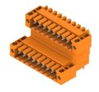
Striscia di connettori maschio stratificati su due livelli per saldatura a onda in passo 3,50 mm. Disponibili in versione chiusa e con flangia. I connettori maschio dispongono di spazio per la siglatura e sono codificabili.
