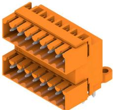
Connettori maschio su due file per saldatura ad onda nel passo 3,50 mm. Il giunto è disponibile in versione aperta, chiusa e con flangia. I connettori maschio dispongono di spazio per la siglatura e sono codificabili. Imballaggio in scatole di cartone.
