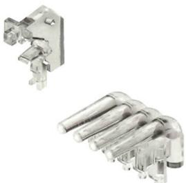
Efficace: il collegamento tra il LED e il pannello anteriore. Gli indicatori luminosi permettono agli utenti di monitorare gli stati di commutazione senza che sia necessario un design speciale: la plastica ottica dirige la luce dai LED standard intorno a una curva nei connettori o attraverso la piastra anteriore.
