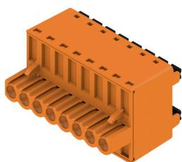
La forte soluzione "Daisy-Chain" per applicazioni di bus di segnali potenti si presta anche per catene di energia ausiliaria da 400V con una corrente di carico max. di 18,5A. Il grande volume di contatto con una sezione del cavo fino a 2,5mm<sup>2</sup>, grazie alla minore caduta di tensione, è particolarmente vantaggioso con cavi bus lunghi o con correnti elevate.
