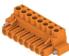
Connettore femmina con sistema di collegamento a vite con staffa di serraggio per il collegamento di fili con conduttore dritto (180°). I connettori femmina dispongono di uno spazio per la siglatura e sono codificabili. Fissaggio per mezzo di flangia o barretta di sgancio. Dispongono anche di una vite più/meno integrata, a protezione contro un errato innesto del cavo, e sono consegnati con le staffe di serraggio aperte. HC = High Current (a corrente forte).
