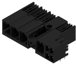
Combinazione con striscia di connettori maschio a 90° con contatti di potenza e segnale, con tecnica di collegamento PUSH IN, compreso dispositivo di blocco della flangia centrale autobloccante e collegamento schermato ad innesto (opzionale) con passo 7,62. Consente il collegamento simultaneo di potenza, segnali e schermatura EMC (opzionale). Ideale per il collegamento di servocomandi e comandi asincroni.
