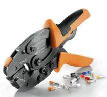
Pinza crimpatrice per terminali con e senza collare isolante
