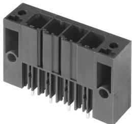
Striscia di connettori maschio su una fila, ad alte prestazioni, affiancabili senza perdita di poli o con flangia brevettata per un fissaggio rapido, senza utensili. Massima affidabilità di collegamento e funzionamento grazie ad un contoprofilo che impedisce errori di collegamento, con diversità di codifica univoca e fissaggio supplementare nella flangia. Lunghezza codolo 3,5 mm ottimizzato per saldatura ad onda senza piombo.
