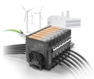
Le serie ACT20C sono state progettate in modo mirato per applicazioni con processi continui. Ciò consente il controllo continuo dei dispositivi diagnostici e delle informazioni di processo ("monitoraggio di stato") Diversi componenti ACT20C formano una stazione consistente in un gateway Ethernet ACT20C, convertitori e separatori di segnali comunicativi ACT20C e un morsetto di terminazione bus ACT20C.
