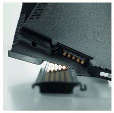
Opzione di alimentazione elettrica aggiuntiva tramite bus
