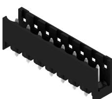
Connettore maschio aperto, diritto, resistente alle alte temperature Imballaggio in scatola o Tape. Su Tape e con codolo a saldare da 1,5 mm, ottimizzati per l'equipaggiamento automatico. Codolo a saldare da 3,2 mm, indicato per saldatura reflow e a onda. Le strisce di connettori maschio presentano uno spazio per la siglatura e sono codificabili. HC = High Current (a corrente forte).
