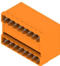
Connettori maschio a due piani con layout d#92 innesto parallelo. La lunghezza dei codoli a saldare è ottimizzata per saldature ad onda. I connettori presentano uno spazio per la siglatura e possono essere codificati.
