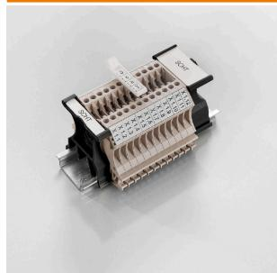
I portacartellini di gruppo SchT 5 S sono fissati direttamente alla guida di supporto TS 32 (guida G) o TS 35 (guida DIN). Quindi l'identificazione della morsettiera è possibile indipendentemente dal punto di serraggio e dal tipo di morsetto.
