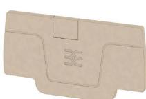
Le piastre terminali sono fissate sul lato aperto dell'ultimo morsettoo componibile prima del terminale di fissaggio. Inserendo la piastra terminale viene mantenuta la funzione del morsetto così come la tensione di dimensionamento indicata. È garantita una protezione contro parti sotto tensione e il morsetto terminale è sicuro per le dita.
