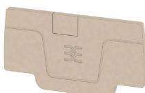
Le piastre terminali sono fissate sul lato aperto dell'ultimo morsetto componibile prima del terminale di fissaggio. Inserendo la piastra terminale viene mantenuta la funzione del morsetto così come la tensione di dimensionamento indicata. È garantita una protezione contro parti sotto tensione e il morsetto terminale è sicuro per le dita.
