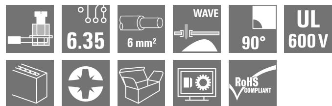
Questo morsetto PCB nel passo 6,35 mm, con collaudato collegamento a staffa di serraggio, ha le seguenti caratteristiche: collegamenti per 1000 V, 32 V, sezione conduttrice da 6 mm<sup>2</sup>, codoli a saldare bilanciati, direzione d'uscita del conduttore a 90°.
