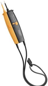
Il compito principale del tester è quello di rilevare l'assenza di tensione. Un tester della tensione a 2 poli è l'unico strumento di controllo consentito in quanto soddisfa i requisiti delle leggi sulla protezione antinfortunistica.
