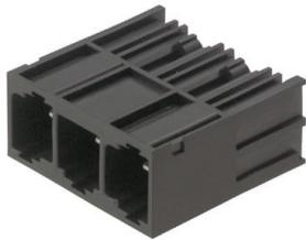
Striscia di connettori maschio su una fila, ad alte prestazioni, affiancabili senza perdita di poli o con flangia brevettata per un fissaggio rapido, senza utensili. Massima affidabilità di collegamento e funzionamento grazie ad un controprofilo che impedisce errori di collegamento, con diversità di codifica univoca e fissaggio supplementare nella flangia. Lunghezza codolo di 3,5 mm ottimizzata per saldatura ad onda, direzione d'innesto a 270° rispetto ai codoli a saldare.
