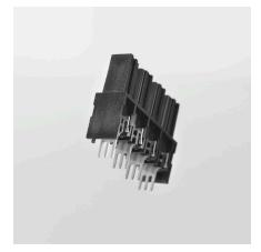
Tre codoli a saldare per polo assicurano la forza meccanica necessaria garantendo al contempo la massima corrente per dati.
