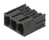
Striscia di connettori maschio su una fila, ad alte prestazioni, affiancabili senza perdita di poli o con flangia brevettata per un fissaggio rapido, senza utensili. Massima affidabilità di collegamento e funzionamento grazie ad un controprofilo che impedisce errori di collegamento, con diversità di codifica univoca e fissaggio supplementare nella flangia. Lunghezza codolo di 3,5 mm ottimizzata per saldatura ad onda, direzione d'innesto a 270° rispetto ai codoli a saldare.
