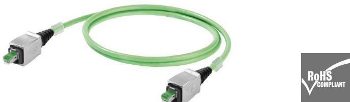
Cavi IE confezionati, PROFINET, Cat.5, PUR, verdi, adatti per l'installazione in catene portacavi, connettori PushPull con rivestimento ad estrusione secondo IEC 61076-3-117 Var.14
