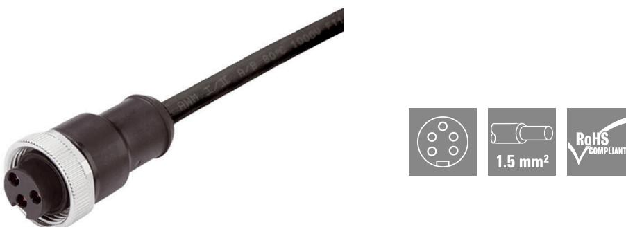
I cavi sensori-attuatori vengono utilizzati per collegare sensori e attuatori e per trasmettere dati o corrente in diverse applicazioni. Il cavo con rivestimento ad estrusione garantisce di fabbrica il collegamento testato tra il connettore ad innesto e il cavo. I cavi possono infatti essere esposti a numerosi influssi, come umidità, polvere, calore, freddo, urti e vibrazioni.
