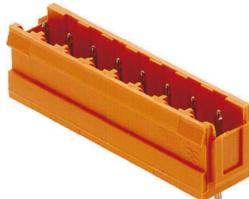
Connettori maschio diritti, codificabili, con stabilità dimensionale e con protezione integrata contro gli inserimenti errati della famiglia di connettori Unimate Range. Disponibili in versione chiusa o aperta. Nella variante chiusa si possono montare blocchetti di fissaggio. I codoli a saldare da 3,2 mm sono ottimizzati per la saldatura ad onda. Confezionati in scatole di cartone.
