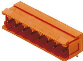
Connettori maschio angolati, codificabili, con stabilità dimensionale e con protezione integrata contro gli inserimenti errati della famiglia di connettori Unimate Range. Disponibili in versione chiusa o aperta. Nella variante chiusa si possono montare blocchetti di fissaggio. I codoli a saldare da 3,2 mm sono ottimizzati per la saldatura ad onda. Confezionati in scatole di cartone.
