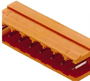
Connettori maschio angolati, codificabili, con stabilità dimensionale e con protezione integrata contro gli inserimenti errati della famiglia di connettori Unimate Range. Disponibili in versione chiusa o aperta. Nella variante chiusa si possono montare blocchetti di fissaggio. I codoli a saldare da 3,2 mm sono ottimizzati per la saldatura ad onda. Confezionati in scatole di cartone.
