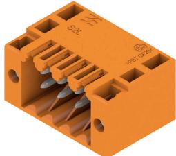
Connettore maschio angolati a due file nelle versioni con chiusura laterale o con flangia (connettori maschio aperti lateralmente disponibili a richiesta). I connettori maschio da 3,5 mm sono idonei alla saldatura ad onda e sono forniti in una scatola. È possibile un avvitamento sul circuito stampato. I connettori presentano uno spazio per la siglatura e possono essere codificati.
