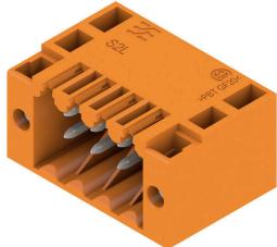
Connettori maschio angolati a due file nelle versioni con chiusura laterale o con flangia (connettori maschio aperti lateralmente disponibili a richiesta). I connettori maschio da 3,5 mm sono idonei alla saldatura ad onda e sono forniti in una scatola. È possibile un avvitamento sul circuito stampato. I connettori presentano uno spazio per la siglatura e possono essere codificati.
