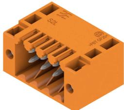
Connettore maschio angolati a due file nelle versioni con chiusura laterale o con flangia (connettori maschio aperti lateralmente disponibili a richiesta). I connettori maschio da 3,5 mm sono idonei alla saldatura ad onda e sono forniti in una scatola. È possibile un avvitamento sul circuito stampato. I connettori presentano uno spazio per la siglatura e possono essere codificati.
