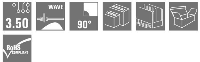
Connettori maschio su due file per saldatura ad onda nel passo 3,50 mm. Il giunto è disponibile in versione aperta, chiusa e con flangia. I connettori maschio dispongono di spazio per la siglatura e sono codificabili. Imballaggio in scatole di cartone.
