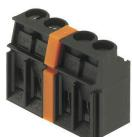
La tensione massima si basa sulla distanza minima. Le piastre intermedie aumentano le distanze di dispersione e di isolamento tra i diversi potenziali e consentono tensioni nominali più elevate o una netta separazione, ad esempio tra la rete elettrica e le tensioni basse o le diverse zone di protezione.
