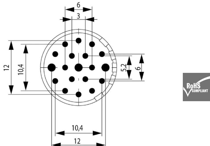
I connettori maschio M23 tondi consentono un numero elevato di cicli d'accoppiamento, forte corrente di carico e alta densità di contatto unitamente a dimensioni minime. Custodie, inserti e contatti a crimpare devono essere ordinati separatamente.
