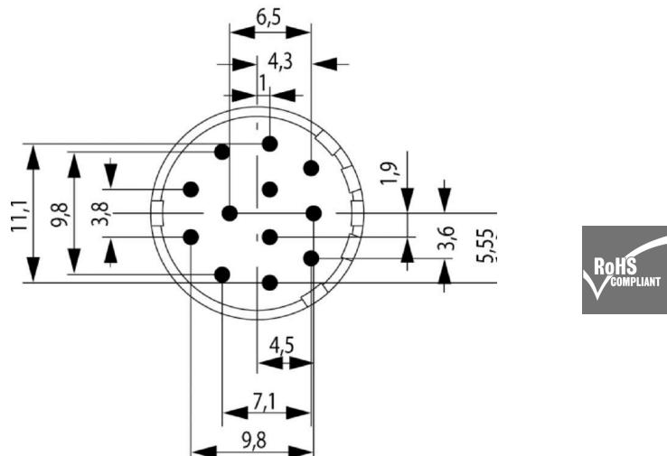
I connettori maschio M23 tondi consentono un numero elevato di cicli d'accoppiamento, forte corrente di carico e alta densità di contatto unitamente a dimensioni minime. Custodie, inserti e contatti a crimpare devono essere ordinati separatamente.
