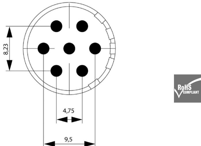
I connettori maschio M23 tondi consentono un numero elevato di cicli d'accoppiamento, forte corrente di carico e alta densità di contatto unitamente a dimensioni minime. Custodie, inserti e contatti a crimpare devono essere ordinati separatamente.
