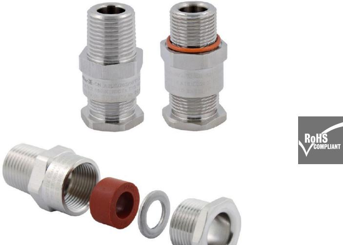
I pressacavi di tipo A2L sono adatti a un cavo non armato, mantengono una protezione a prova di fiamma Ex d e contro le esplosioni a sicurezza aumentata Ex e.
