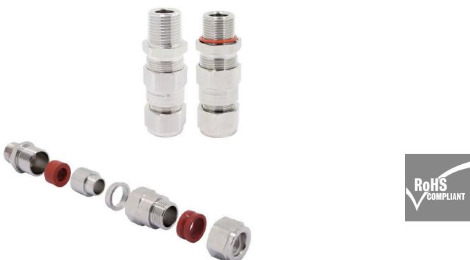
I pressacavi di tipo E1W sono adatti ai cavi armati in filo d'acciaio SWA e mantengono una protezione a prova di fiamma Ex d e contro le esplosioni a sicurezza aumentata Ex e. Inoltre il morsetto armato assicura il legame elettrico tra il cavo armato e i pressacavi.
