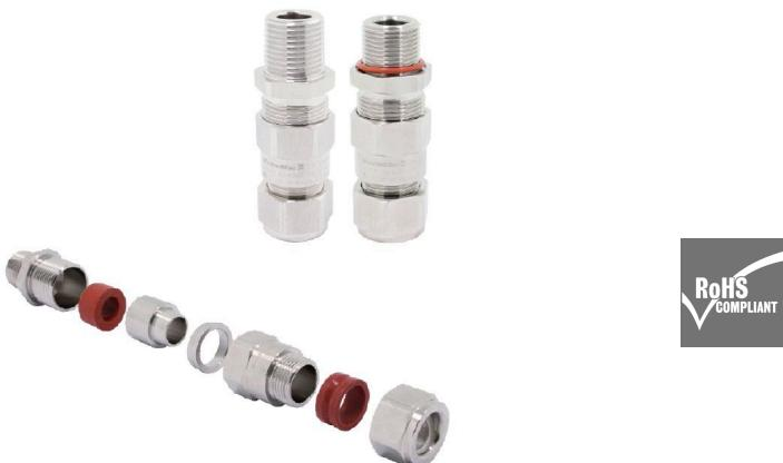
I pressacavi di tipo E1W sono adatti ai cavi armati in filo d'acciaio SWA e mantengono una protezione a prova di fiamma Ex d e contro le esplosioni a sicurezza aumentata Ex e. Inoltre il morsetto armato assicura il legame elettrico tra il cavo armato e i pressacavi.
