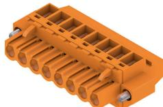
Connettori femmina con collegamento con staffa di serraggio per il collegamento di fili con conduttore angolato a destra (90° o 270°). I connettori femmina dispongono di uno spazio per la sigillatura e sono codificabili. Fissaggio per mezzo di flangia o barretta di sgancio. Dispongono anche di una vite più/meno integrata, a protezione contro un errato innesto del cavo, e sono consegnati con le staffe di serraggio aperte. HC = High Current (a corrente forte).
