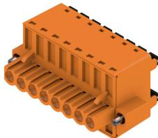
La forte soluzione "Daisy-Chain" per applicazioni di bus di segnali potenti si presta anche per catene di energia ausiliaria da 400V con una corrente di carico max. di 18,5A. Il grande volume di contatto con una sezione del cavo fino a 2,5mm<sup>2</sup>, grazie alla minore caduta di tensione, è particolarmente vantaggioso con cavi bus lunghi o con correnti elevate. Le 4 versioni a flangia, compresa la levetta di sgancio brevettata, danno vita a un concetto di bloccaggio orientato all'utente.
