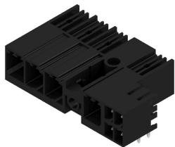
Combinazione con striscia di connettori maschio a 90° con contatti di potenza e segnale, con tecnica di collegamento PUSH IN, compreso dispositivo di blocco della flangia centrale autobloccante e collegamento schermato ad innesto (opzionale) con passo 7,62. Consente il collegamento simultaneo di potenza, segnali e schermatura EMC (opzionale). Ideale per il collegamento di servocomandi e comandi asincroni.
