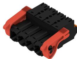
Striscia di connettori maschio inversi a 180° con tecnologia di collegamento PUSH IN per il cablaggio in campo da 2,5 mm<sup>2</sup> con passo 7,62. Ideale anche come soluzione di protezione contro i contatti accidentali per le tensioni inverse.
