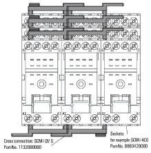
Ponticelli di collegamento trasversale allo stesso collegamento sulla base vicina
