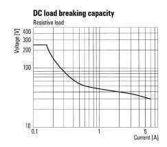
Curva limite di carico DC Carico ohmico
