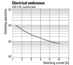
Durata elettrica230 V AC resistive load Carico ohmico 230 V AC
