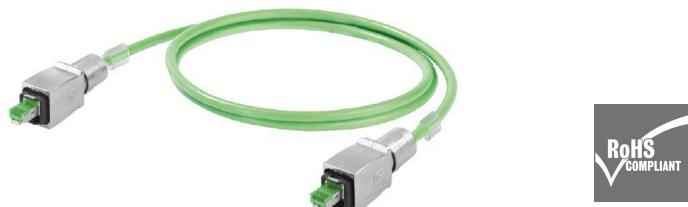
Cavi IE confezionati, PROFINET, Cat.5, PUR, verdi, adatti per l'installazione in catene portacavi, connettori PushPull secondo IEC 61076-3-117 Var.14
